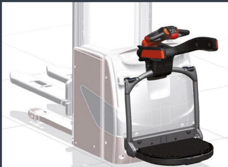
A plataforma, as proteções laterais e o timão compõem uma única estrutura totalmente suspensa e isolada do chassis através de 4 pontos de união. Esta configuração reduz ao mínimo as vibrações sentidas pelo operador e melhora o conforto durante o seu dia de trabalho. Este design inovador garante também uma vida útil prolongada do próprio stacker.
