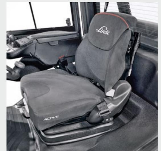
Conforto de elevada qualidade para longos períodos de utilização. O **“Activo Super Conforto”** com assento ergonómico e apoio lombar é o primeiro equipamento de controlo de temperatura com ventilação activa do mundo instalado num empilhador.
