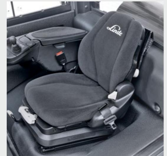
Além de uma cobertura em tecido resistente à abrasão, o **assento confortável**, revestido a carbono ativo, oferece um apoio lombar mecânico e uma suspensão pneumática opcional.
