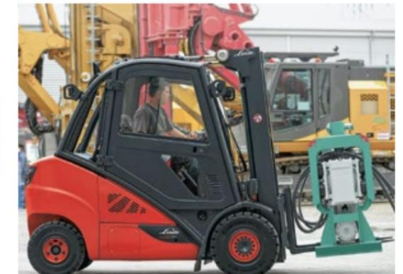
Usando o **amortecimento electrónico na posição final**, evita recuos bruscos quando os cilindros de inclinação chegam à posição final.
