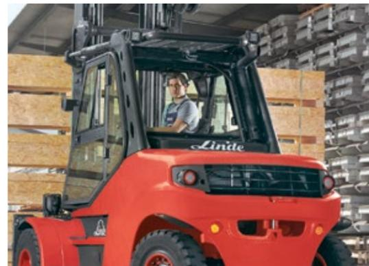
**Rotação do posto de trabalho do operador** com pedais e dispositivos de operação a rodarem integralmente. Quer seja a deslocar-se para a frente ou em marcha-atrás, com um leve movimento de cabeça o condutor consegue ver a carga e o percurso
