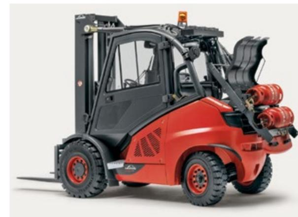
**Substituição ergonómica das botijas** usando GPL. O operador não precisa de aplicar força desnecessária.
