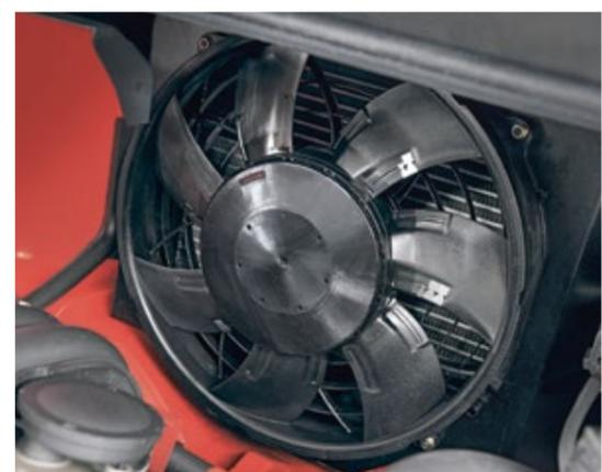
**Sofisticação até ao mais pequeno detalhe.** A ventoinha eléctrica recentemente desenvolvida adapta a sua velocidade à temperatura do óleo hidráulico, do líquido de arrefecimento e ar de carga, tornando-o significativamente mais económico.
