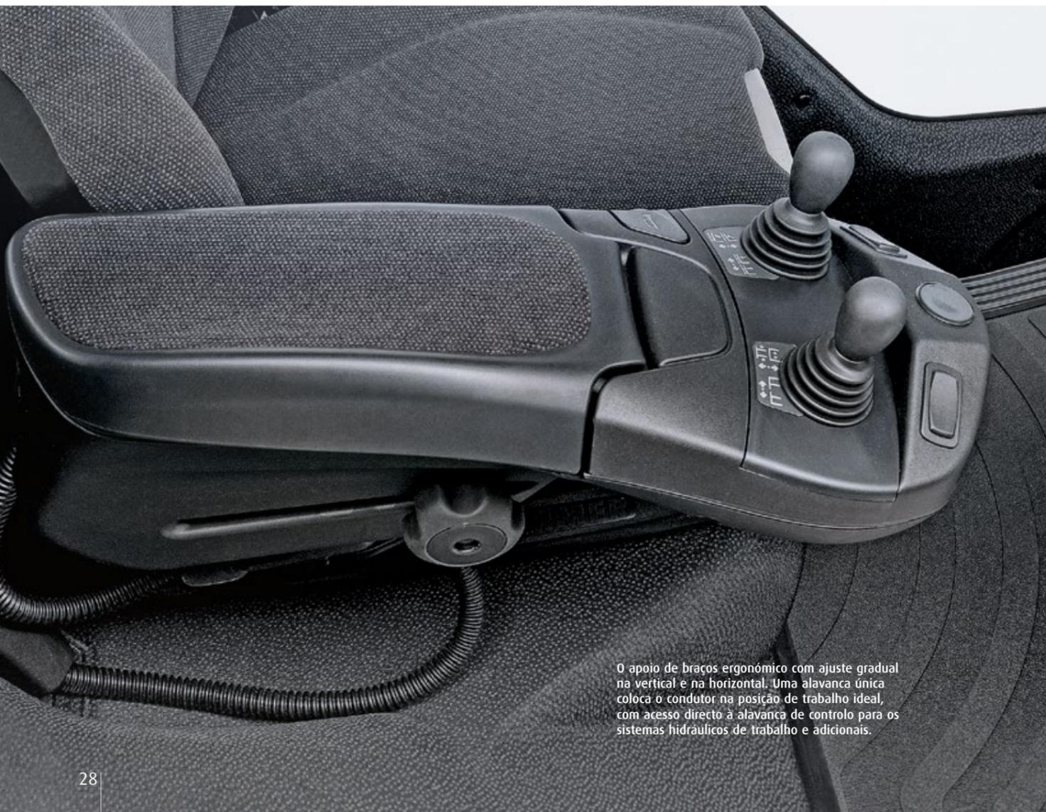
O apoio de braços ergonómico com ajuste gradual na vertical e na horizontal. Uma alavanca única coloca o condutor na posição de trabalho ideal, com acesso directo à alavanca de controlo para os sistemas hidráulicos de trabalho e adicionais.
