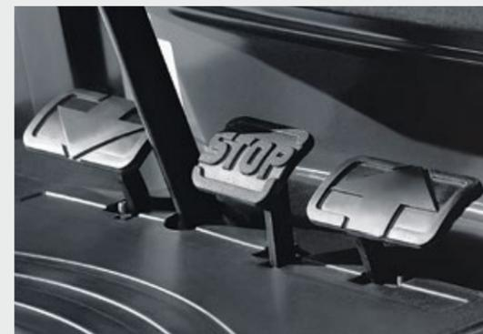
Movimento para a frente e para trás sem necessidade de mudar de pés, graças ao pedal duplo de comando Linde.
