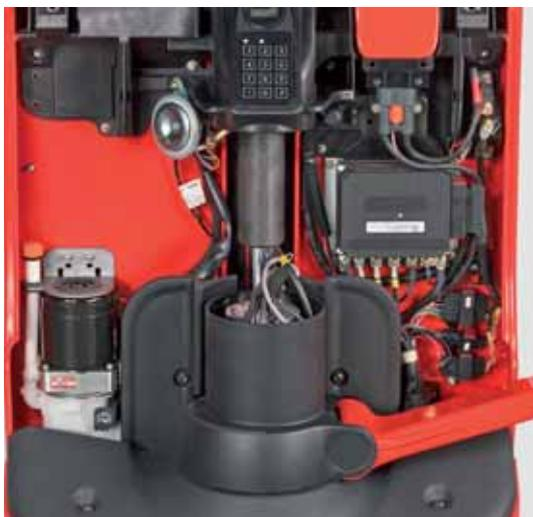
**Acesso rápido, desgaste reduzido.** O painel de serviço do motor oferece um acesso rápido e fácil a todos os componentes internos. Dado que todos os cabos eléctricos estão devidamente protegidos, a manutenção é rápida. O sistema de travagem electromagnética aumenta os intervalos pela redução dos desgastes.
