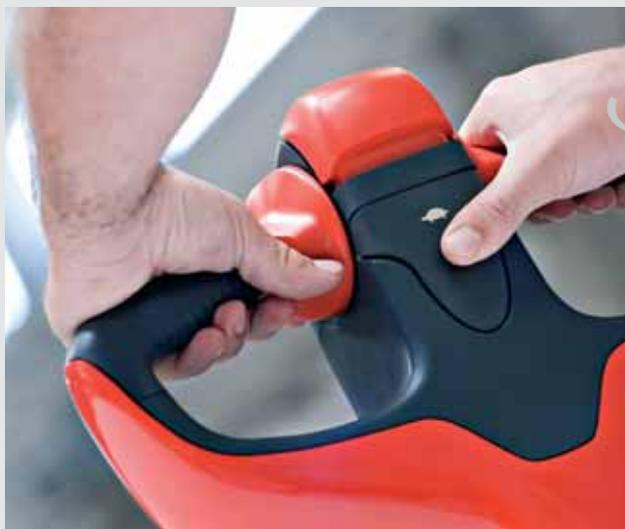
**Velocidade muito reduzida.** A característica de velocidade muito reduzida da Linde permite a realização de manobras em áreas confinadas com o timão direito, normalmente um dos pontos de travagem. Ao activar-se o comando de Velocidade muito reduzida, acessível com ambas as mãos, é determinada a velocidade mínima de 1.5km/h. O operador poderá, assim, manobrar livre e facilmente a máquina numa plataforma elevatória durante a carga ou descarga.
