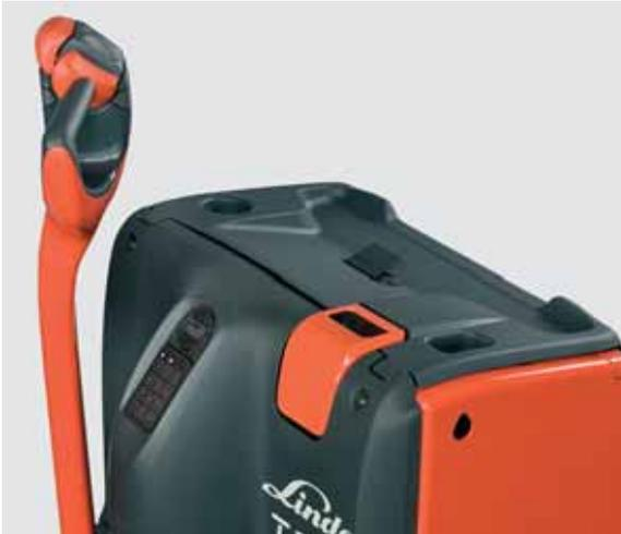
**Compartimentos de armazenamento.** Cada um dos empilhadores está equipado com compartimentos de fácil alcance por parte do operador, de forma a que este possa otimizar o seu trabalho. Amplos e fundos, estes compartimentos permitem guardar devidamente e de modo seguros quaisquer objectos como agasalhos, canetas, marcadores e outros.
