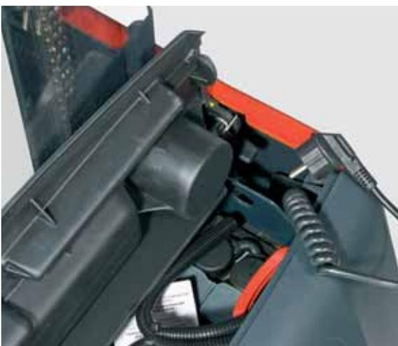
**Carregador incorporado.** Os equipamentos podem ser equipados com carregadores incorporados com vista a uma maior flexibilidade, sempre e quando for necessário. O cabo do carregador e a tomada são facilmente guardados para um uso fácil e seguro. Este carregador permite carregar baterias de gel e acumuladores de chumbo até 375 Ah com um simples toque de interruptor.
