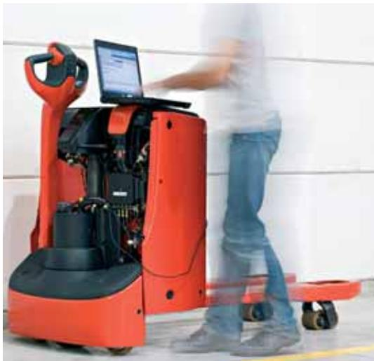
**Arquitectura CAN-bus.** Além dos ajustamentos rápidos para o funcionamento dos parâmetros, a tecnologia inteligente CAN-Bus oferece ainda um espectro amplo de diagnóstico acerca do estado técnico da máquina, bem como a correcta manutenção. Esta controla, assim, cuidadosamente todas as funções-chave com vista a um diagnóstico rápido e simples por parte de um engenheiro de serviço.
