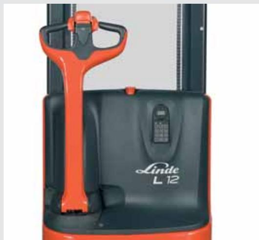
**Timão descentrado (off-centred).** As séries 1172 possuem um formato de cabeça de timão descentrado único e que permite manter o operador em perfeita segurança no interior dos contornos do stacker enquanto é possibilitada uma excelente visibilidade através do mastro.
