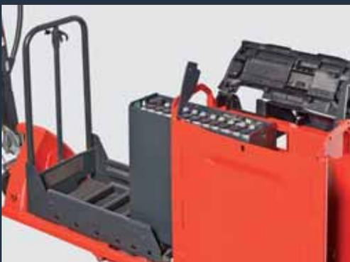
Fácil troca lateral de bateria. A opção de troca lateral de bateria permite uma ligação simples e fácil desta. Fácil de operar e muito segura, o equipamento de mudança rápida permite a rotação da bateria para qualquer um dos lados da máquina. O seu sistema de fecho especial faz com que a bateria seja mantida de forma segura no seu lugar. A troca vertical de bateria, enquanto equipamento Standard, é também possível.
