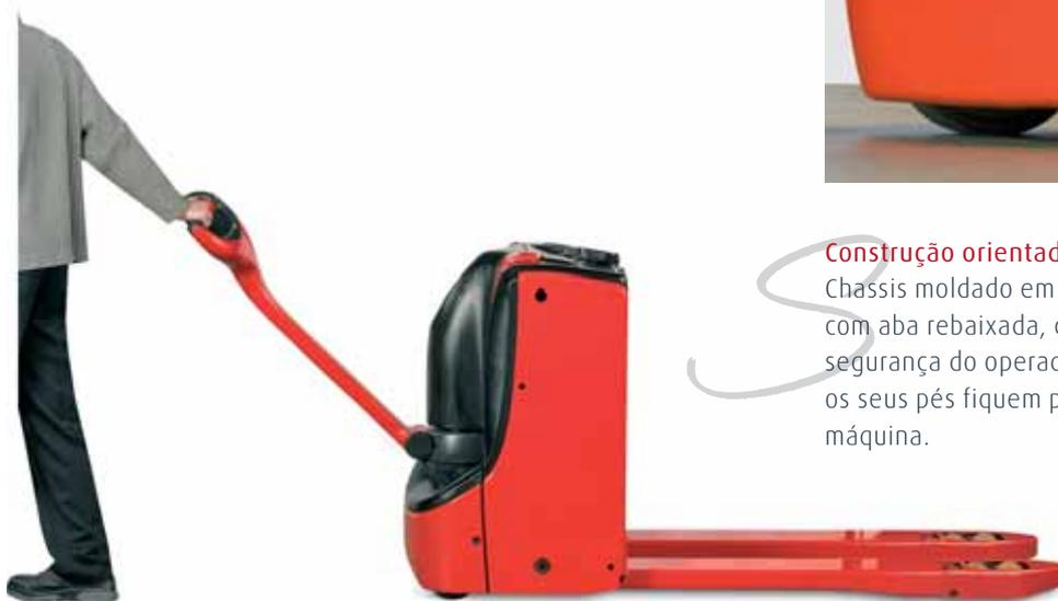
**Timão longo e de montagem inferior.** Um braço de timão longo equipado com um ponto baixo de montagem que assegura um espaço de segurança amplo entre o operador e o chassis, bem como condução leve para cantos estreitos.
