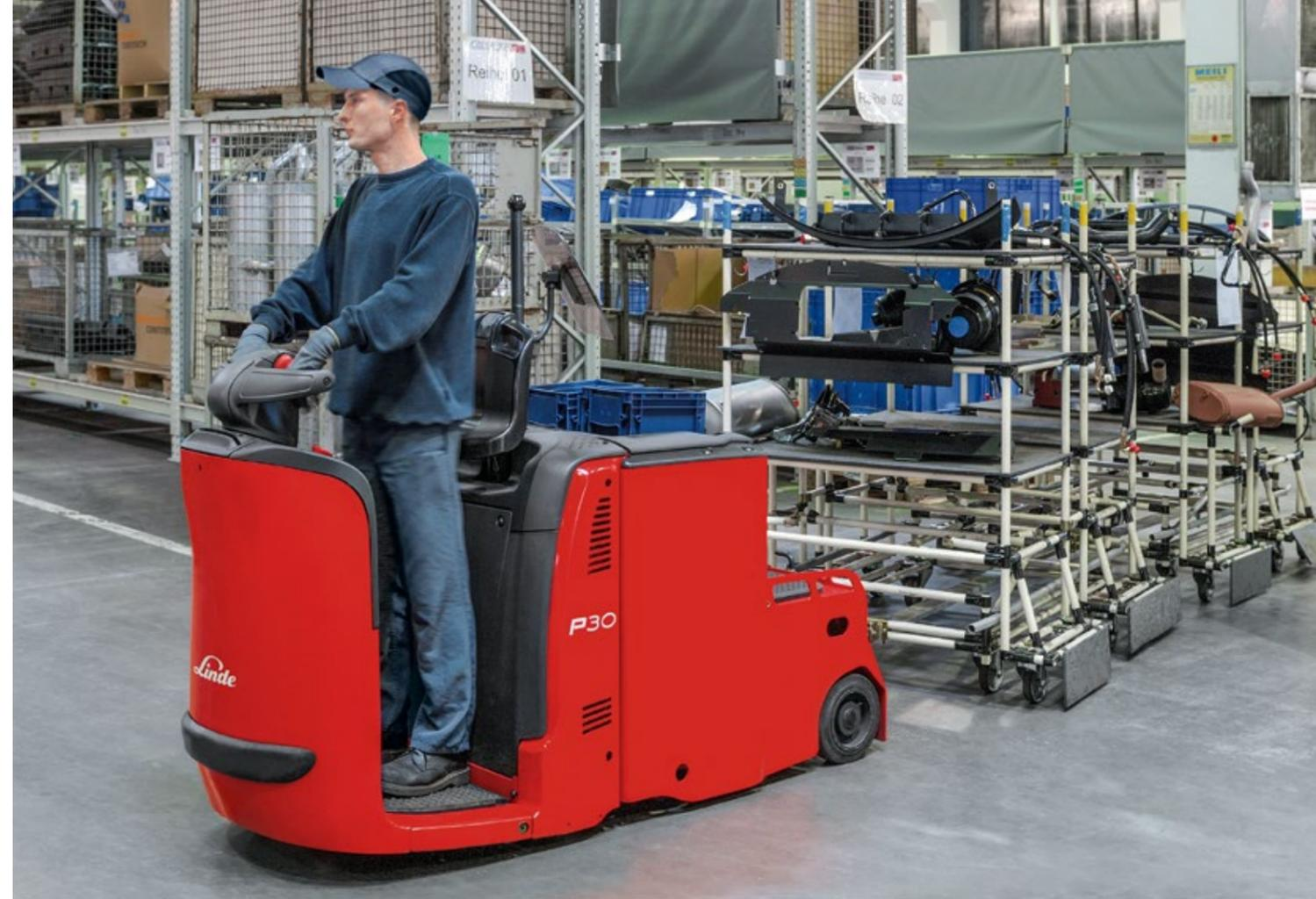
Um ótimo nível de produtividade é alcançado com o design robusto e fiável. A tecnologia de acionamento AC isento de manutenção, combinada com diagnósticos CAN-bus e fácil acesso a todos os componentes-chave para rotinas de serviço, culmina com uma produtividade muito rentável e custos operacionais mais baixos.
