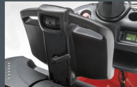
realiza tarefas de transferência intensiva do reboque ou se desloca sobre superfícies irregulares. A estação de trabalho e os principais componentes são efetivamente isolados das vibrações da superfície do piso para um ótimo conforto e vida útil prolongada dos componentes.
