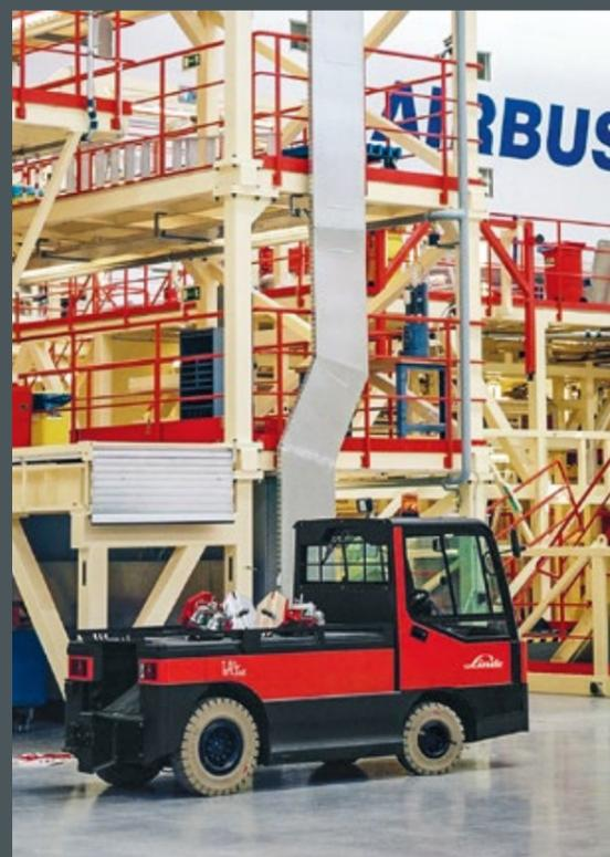
Um degrau baixo facilita o acesso à cabine espaçosa do operador onde o layout automóvel dos pedais, alavanca de direção, volante e controles, juntamente com um assento de suspensão totalmente ajustável proporcionam um ambiente de trabalho confortável e isento de fadiga. Os amortecedores da suspensão da cabine e um sistema de suspensão dianteiro e traseiro por mola garante níveis soberbos de conforto de condução.
