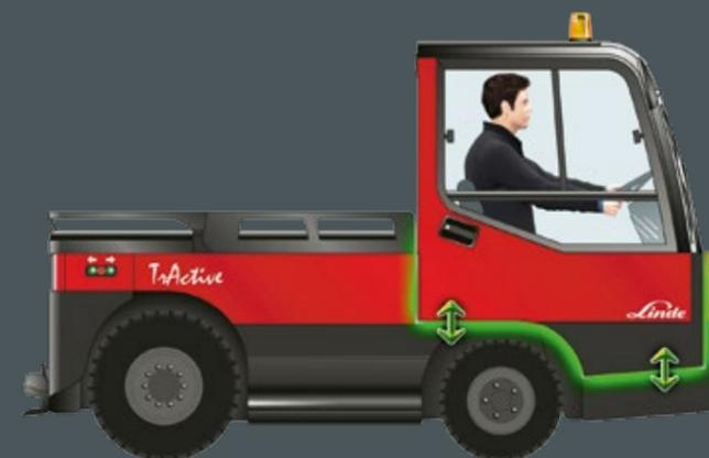
A cabine com suspensão hidráulica nos tratores P250 e W20 contribui significativamente para o conforto do operador e absorve as vibrações da superfície da estrada.
