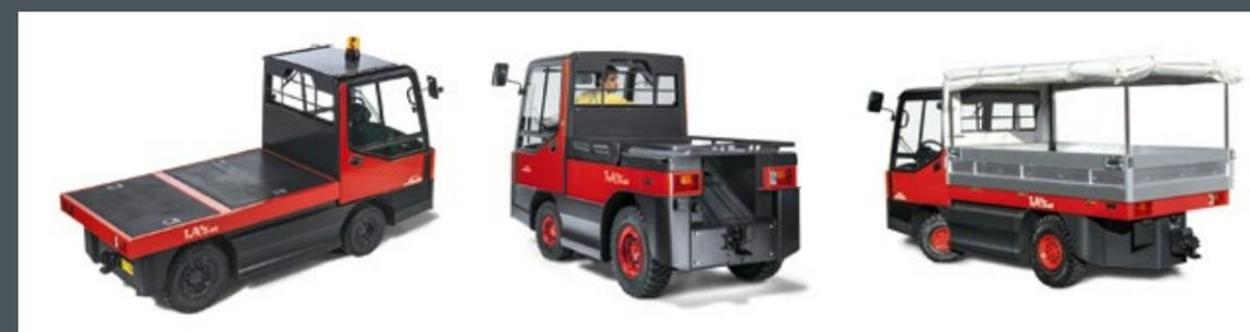
W20 e P250 de reboque plano com corte para uma excelente visibilidade para o acoplamento de reboque, W20 com um toldo flexível e painéis laterais com dobradiça.
