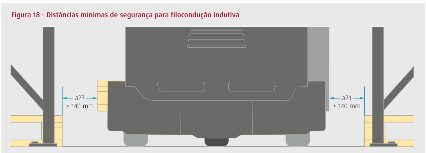
26) Linde: Se a distância for menor, a velocidade de tração do empilhador é reduzida.
