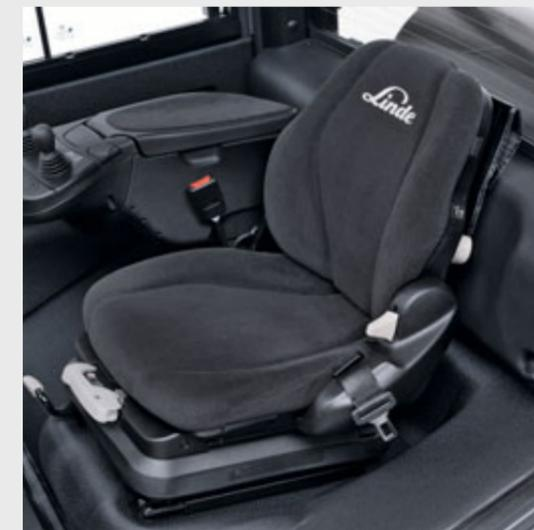
Além de uma cobertura em tecido resistente à abrasão, o **assento confortável** revestido a carvão activado, oferece um apoio lombar mecânico e uma suspensão pneumática opcional.
