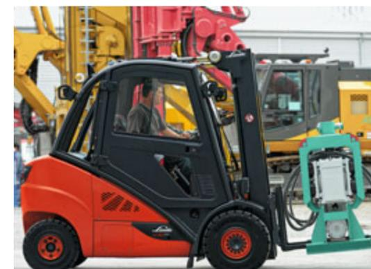
Usando o **amortecimento electrónico na posição final**, evita recuos bruscos quando os cilindros de inclinação chegam à posição final.
