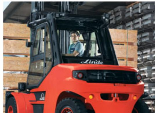
**Rotação da estação de trabalho do condutor** com pedais e dispositivos de operação a rodarem completamente. Quer seja a deslocar-se para a frente ou em marcha-atrás, com um leve movimento de cabeça o condutor consegue ver a carga e o percurso.
