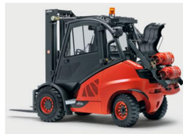
**Substituição ergonómica de garrafas** usando GPL. O condutor não precisa de aplicar força desnecessária.
