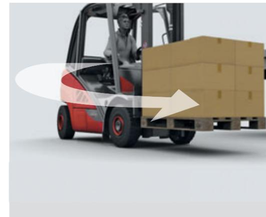
Linde é o primeiro fabricante do mundo a incluir a função de segurança **"Curve Assist"** de série, nos seus modelos H20 – H50. Ao desfazer uma curva demasiadamente rápida, o sistema regula automaticamente a velocidade do empilhador. Isto significa que o empilhador pode ser usado até aos limites da sua eficiência, mas não além.
