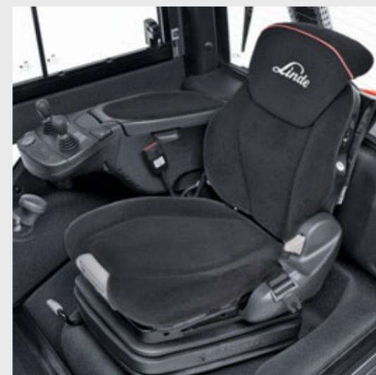
O **assento super confortável** da Linde com suspensão pneumática de série, sistema de aquecimento do assento e do apoio lombar, regulação da extensão do apoio lombar, altura do estofo do assento e ângulo.
