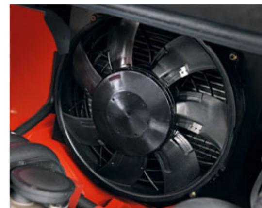
**Sofisticação no mais pequeno detalhe.** A ventoinha eléctrica recentemente desenvolvida adapta a sua velocidade à temperatura do óleo hidráulico, do líquido de arrefecimento e ar de carga, tornando-o significativamente mais económico.
