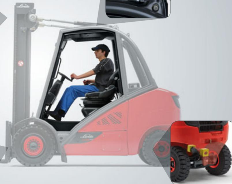
Rolamentos especiais do eixo de direcção reduzem impactos e vibrações causadas por superfícies irregulares
