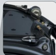
Rolamentos de cilindros de inclinação que não necessitam de manutenção, reduzem o tempo de inactividade e os custos operacionais
