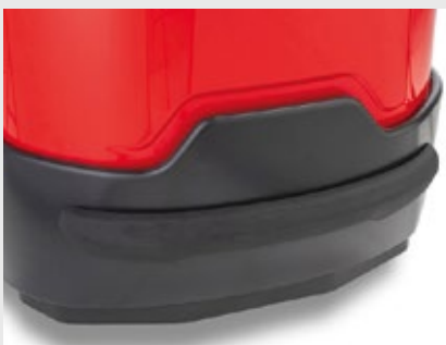
Pára-choques frontal de aço fundido
