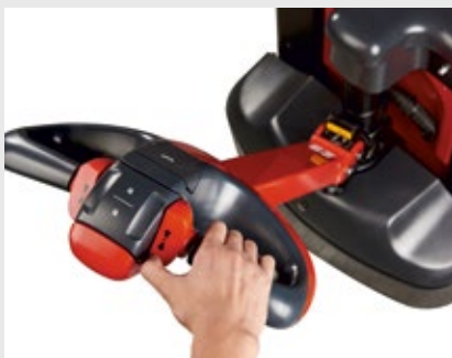
Todos os comandos integrados ergonomicamente na cabeça do timão da Linde
