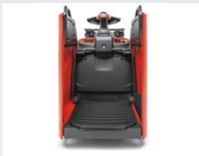
Chassis de aço para proteger o operador
