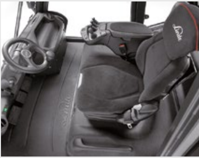
Cabine com suspensão total
