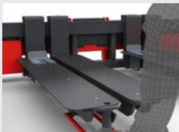
Dispositivo de desbloqueio do garfo com um mecanismo ergonómico de ejeção do garfo no modelo LT-C
