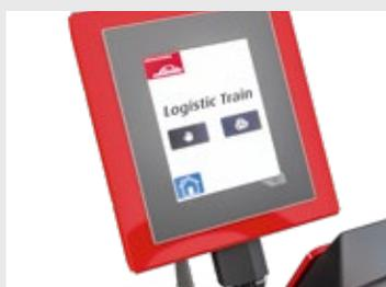
Ecrã tátil no trator de reboque: seleção do modo de elevação e informações sobre o estado dos chassis conectados
