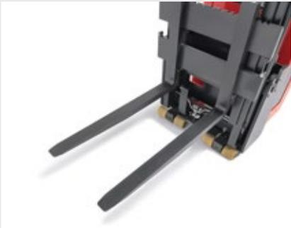
Equipados com garfos padrão ISO, os stackers movimentam qualquer tipo de palete.
