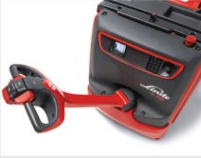
O baixo ponto de ancoragem do timão garante uma ampla distância de segurança entre o operador e o chassis.
